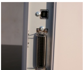
łatwość podłączenia zapewnia złącze równoległe oraz port USB
